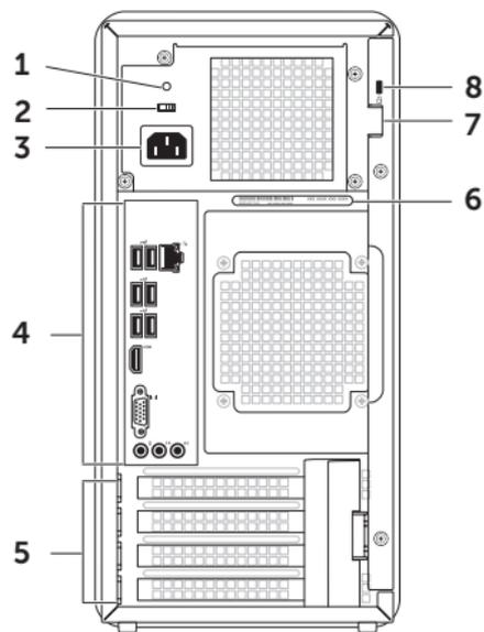
**1 电源设备指示灯** — 指示电源设备的电源可用性。
